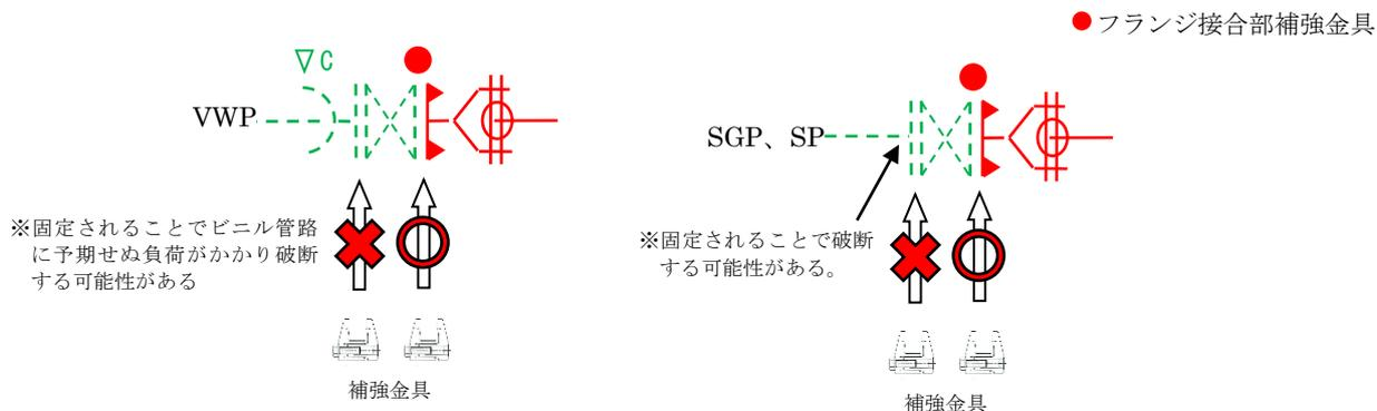
④ 水道配水用ポリエチレン管の EF フランジ、スピゴットフランジはルーズフランジであるため、補強金具が施工できない。
